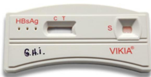
Figura 7a – Dispositivo apresentando um resultado de teste inválido no *kit* Vikia – ausência de linha na zona C e na zona T.
