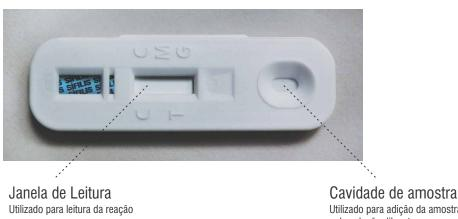
Utilizado para adição da amostra e da solução diluente
